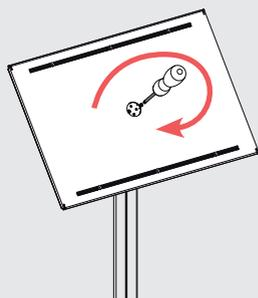
Per il cambio da orizzontale a verticale (o viceversa) allentare le viti e fissarle di nuovo dopo aver modificato l'orientamento.
