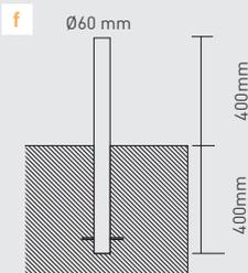
f = supporto per tubi in ferro zincato da interrare con calcestruzzo o fondamenta in cemento.
