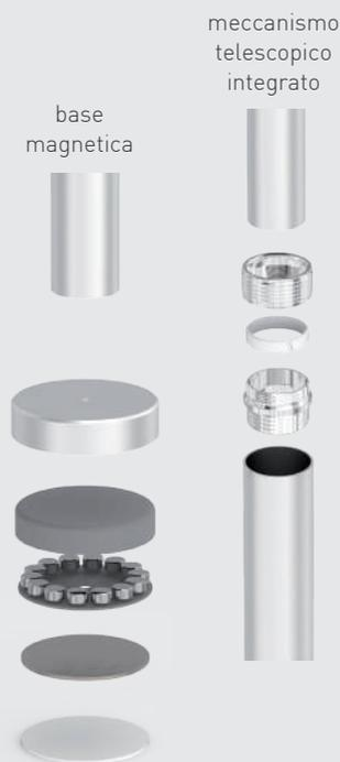
A sinistra, la base con calamita WKP N35 - Ø 52x10,5mm - con foro per vite M6x10mm. A destra, i componenti del meccanismo telescopico.
