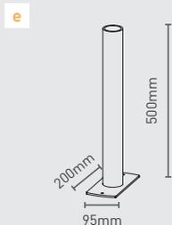
e = supporto per tubi in ferro zincato da avvitare sul terreno/cemento/asfalto.
