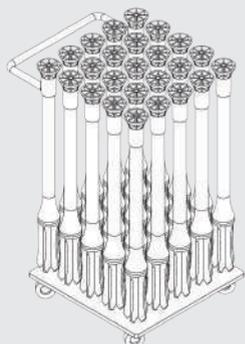
Per trasportare quantità più importanti di Tempaline, c'è anche il pratico carrello che può contenere un massimo di 25 colonnine. Altezza colonnina: 950 mm. Diametro testa: 45 mm. Diametro base: 510 mm
