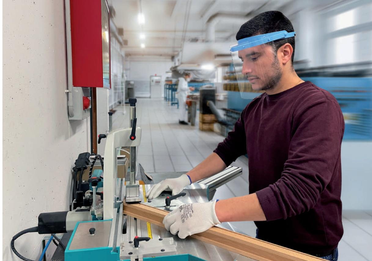
La visiera è ideale per proteggere il viso da schegge o schizzi di materiali pericolosi (foto in alto). Inoltre, tramite il pratico elastico posteriore, la visiera è regolabile in diverse altezze rispetto al viso.
