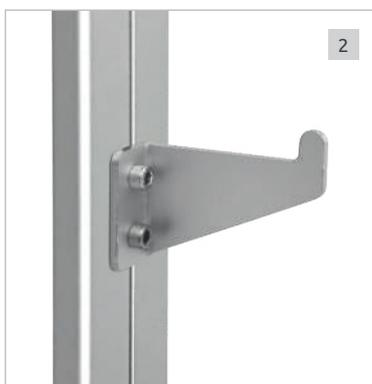
Adattore per la sospensione dell'estintore, alluminio anodizzato color argento, regolabile in altezza, fissato con 2 vitl. Altezza consigliata per l'applicazione: 800mm.
